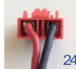
Posizione cablaggi su connettore / Cable positioning in the connector
