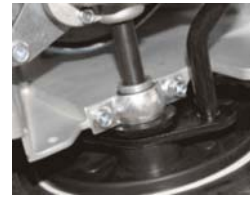
Dvojité masivní uložení ložiska nápravy převodovky
