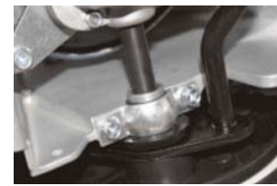
Dvojitě masivní uložení ložiska nápravy převodovky
